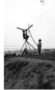
Gambar 10 Pembangkit listrik tenaga angin sumbu horizontal
