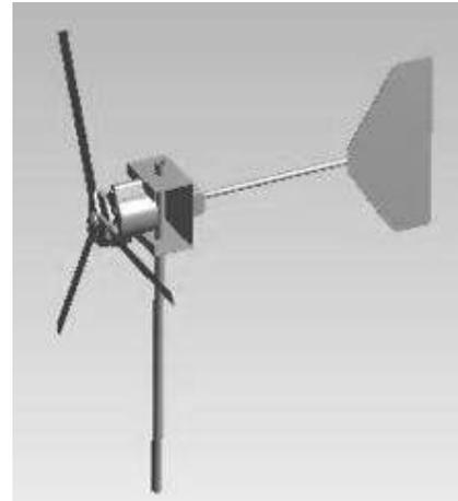
Gambar 4 Desain perancangan turbin angin sumbu horizontal
