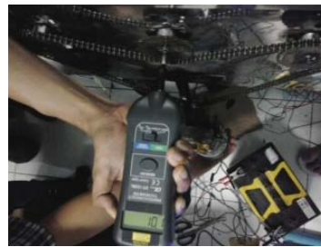
Gambar 4. Pengukuran RPM Putaran Motor Pemanggang Menggunakan Tachometer Laser
