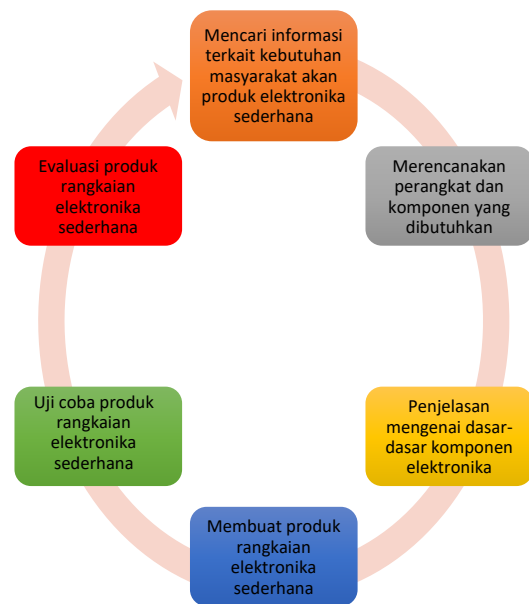
Gambar 2. Tahapan pembuatan rangkaian elektronika sederhana
