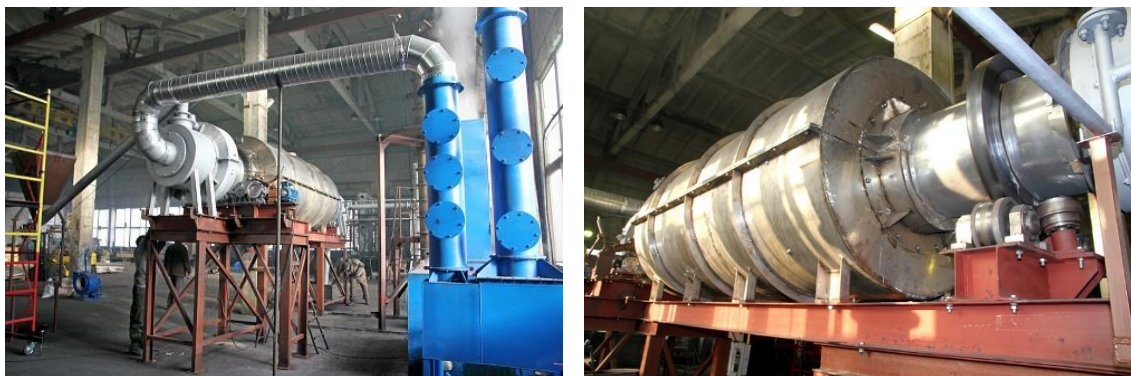
Imagen 7: Instalación de activación térmica
