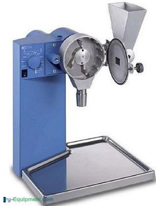
Imagen 44: Molino de martillos para la molienda de biomasa. (IKA, 2020)
