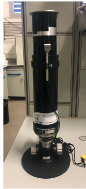
Figura 12: Equipo de medida de permeabilidad al aire Gurley.
