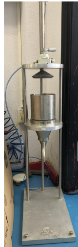
Figura 10: Equipo de medida del índice SR.
