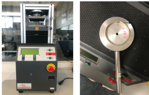
Figura 17: Equipo de ensayo RCT y utensilio de forma de anillo.
