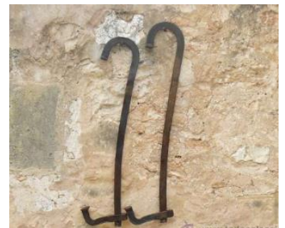
Pareja de Gatos-mordaza de encofrar. https://www.todocoleccion.net/antiguada-des-tecnicas
