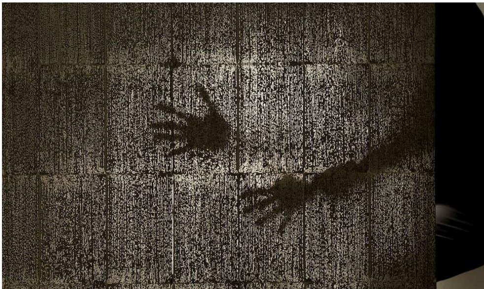
[44] Hormigón translúcido. Litracon
