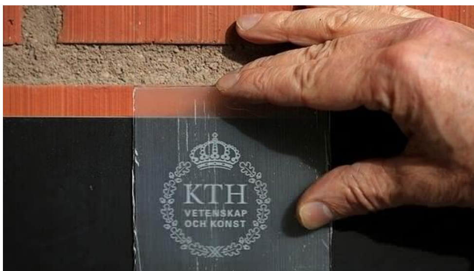
[55] © Fotografía de KTH Royal Institute of Technology . Madera transparente
