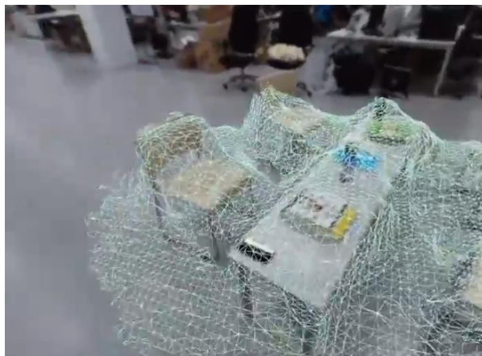
Figura 3.4: Ejemplo del funcionamiento del escaneo espacial de SRWorks ( https://developer.vive.com/resources/vive-sense/sdk/vive-srworks-sdk/ )
