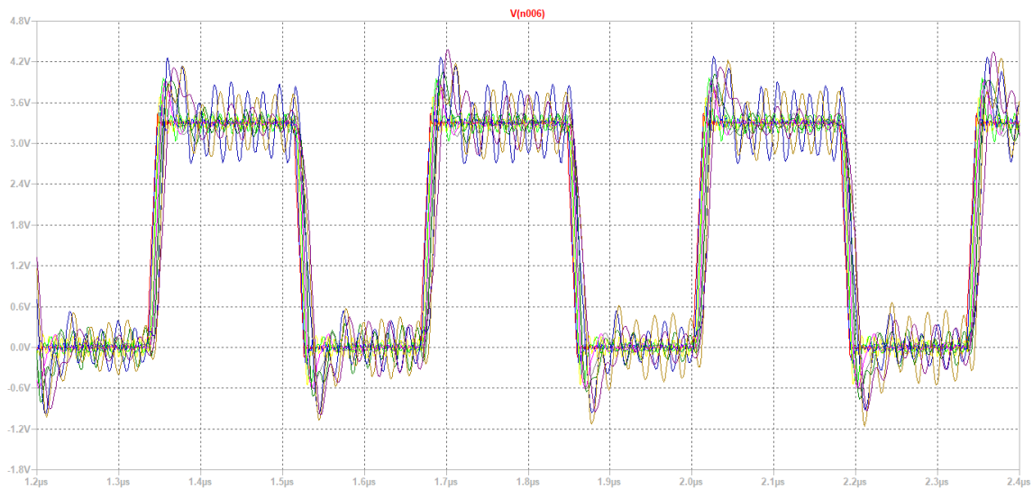
Fig. 29: Resultados de la simulación del crosstalk.
