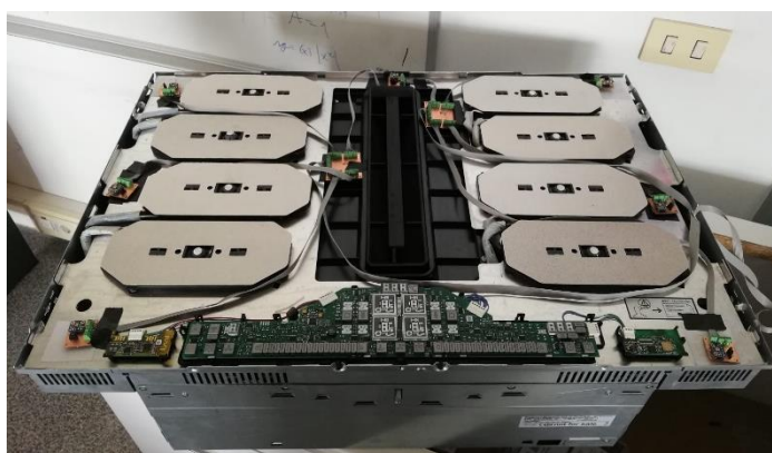
Fig. 42: Vista frontal de la distribución de 8 micrófonos dentro de la cocina
