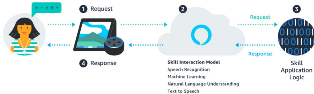
Fig. 1: Esquema del funcionamiento de Alexa[11].
