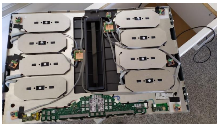
Fig. 43: Vista superior de la distribución de 8 micrófonos dentro de la cocina.
