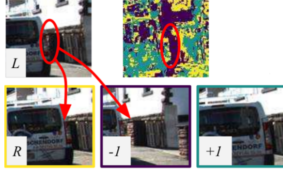
Figura 3.3: Beneficio de usar el error de reproyección mínimo en entrenamiento estéreo-monocular. Los píxeles en la región redondeada de la imagen objetivo I_L se encuentran ocluidos en I_R , así que nos se aplica error entre I_L y I_R . En su lugar, los píxeles son relacionados a I_{t-1} donde sí que son visibles. Los colores en la imagen superior derecha indican de cual de las imágenes origen de la parte inferior proviene cada píxel seleccionado por la ecuación 3.1 para contribuir al valor final de la función de coste. Fuente: Modificado de [37] Copyright © 2019 IEEE.
