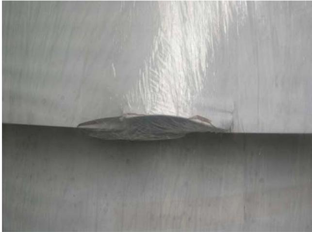
Figura 13. Golpe de rollo con montacarga
