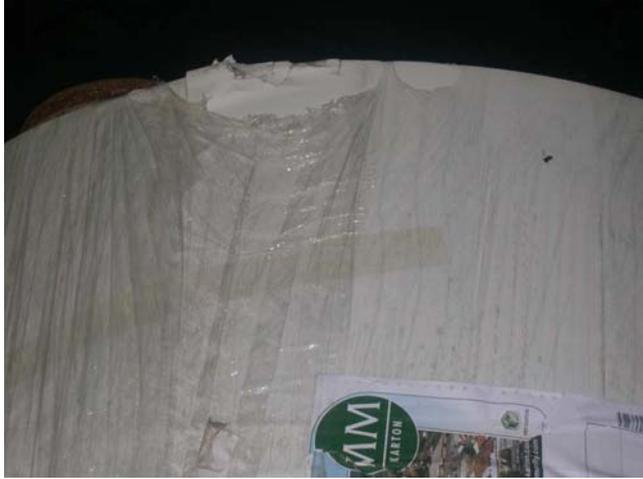
Figura 12. Averías en rollos por manipulación incorrecta con montacarga de uñas
