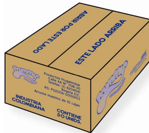
Figura 64. Caja cartón corrugado para envases de 500 cc.
