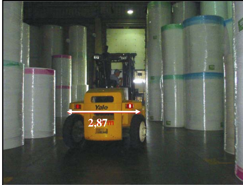
Figura 19. Ancho del montacargas
