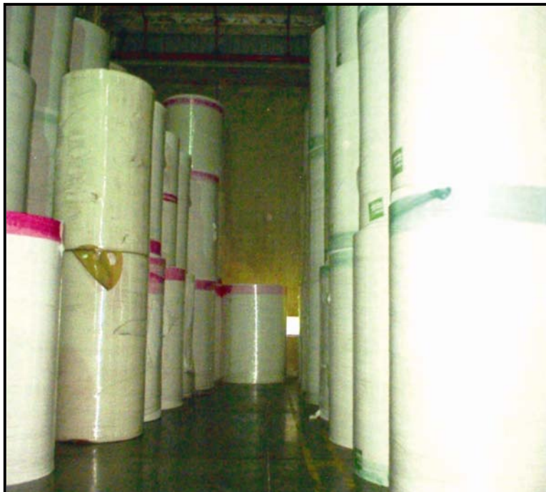
Figura 18. Espacio reducido en los apilamientos de los rollos.
