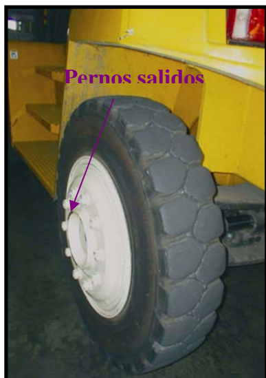
Figura 19. En la figura de la izquierda, pernos salidos de la llanta trasera. Figura de la derecha, maltrato de rollos con pernos del montacargas.
