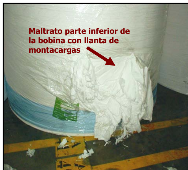
Figura 19. En la figura de la izquierda, pernos salidos de la llanta trasera. Figura de la derecha, maltrato de rollos con pernos del montacargas.
