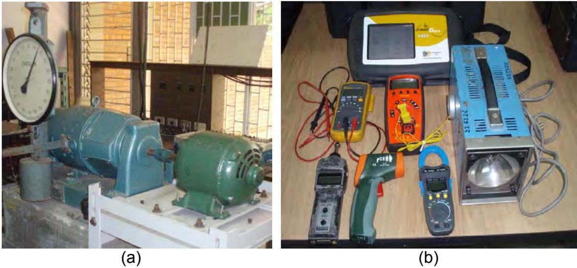
El motor de inducción fue sometido a las pruebas de vacío, rotor bloqueado y secuencia inversa. El montaje para las pruebas se observa en la Figura F.4
