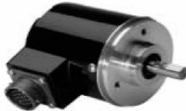
El encoder entrega una serie de pulsos en cuadratura a través de dos canales, y dependiendo de la secuencia que estos tengan se obtiene el incremento o decremento de la posición en que se encuentre el servo. Hay un tercer canal, llamado Índice, el cual indica el término de una vuelta completa del encoder.
