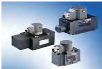
La servoválvula es el elemento que permite controlar el movimiento del cilindro de doble efecto a partir de una señal de consigna en su entrada. Es una válvula de control direccional de infinitas posiciones que ofrece la característica de controlar tanto la cantidad como la dirección del caudal.
