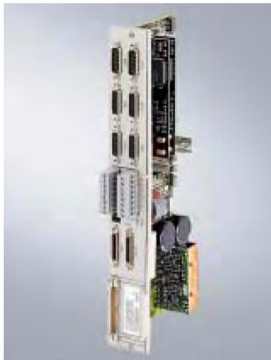
**ACCIONAMIENTO HIDRÁULICO LINEAL (HLA).** La unidad enchufable de regulación digital SIMODRIVE 611 HLA está diseñada para el mando y regulación de servoválvulas electrohidráulicas de accionamientos hidráulicos lineales. Con cada unidad de regulación pueden gobernarse hasta 2 ejes hidráulicos. Insertándola en la caja vacía universal de 50 mm de ancho se completa un módulo
