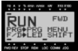
Utilizado para desplegar varios tipos de información tales como el estado de operación y datos de funciones. Un mensaje de guía de operación, se muestra en la parte inferior del monitor LCD. Cuenta con luz integrada, la cual se enciende cuando se aplica el poder de control o cualquier tecla es presionada, esta se mantiene encendida aproximadamente por cinco minutos después de que la última tecla fue presionada.
