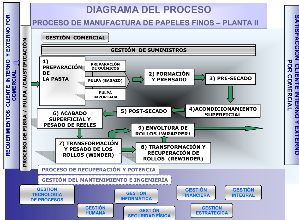
Figura 2 - diagrama de proceso elaboracion del papel
