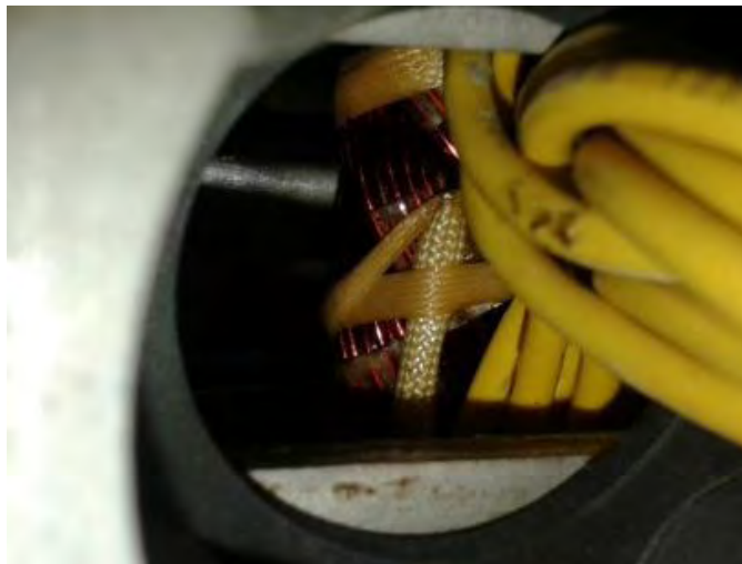
Figura 54. Acceso al motor a través de la bornera
