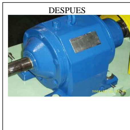
Foto 4. Reductor reparado, rodamientos nuevos y tren de engranaje arreglado.
