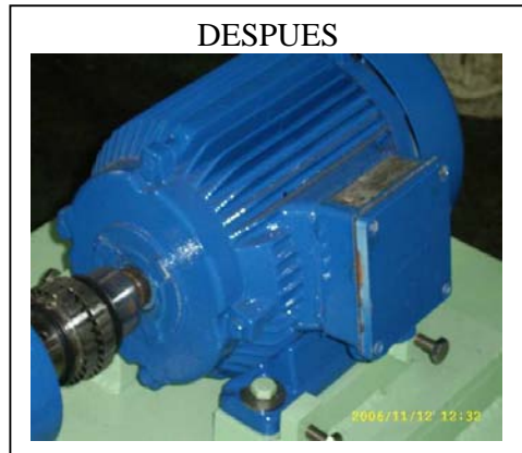
Foto 2. Motor reparado eléctrica y mecánicamente.
