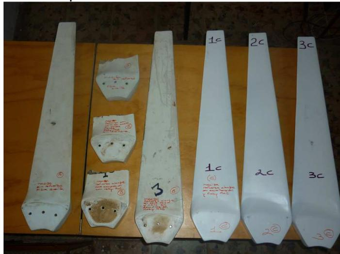
Considerando la teoría de esfuerzos de flexión, donde un elemento alargado sometido a este tipo de esfuerzos tiene una cara a tensión y su opuesta una cara a compresión se emprendió el refuerzo de la cara a tensión. La tensión es el tipo
