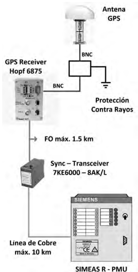
Figura 9. Estructura para la sincronización del tiempo en el Simeas R - PMU
