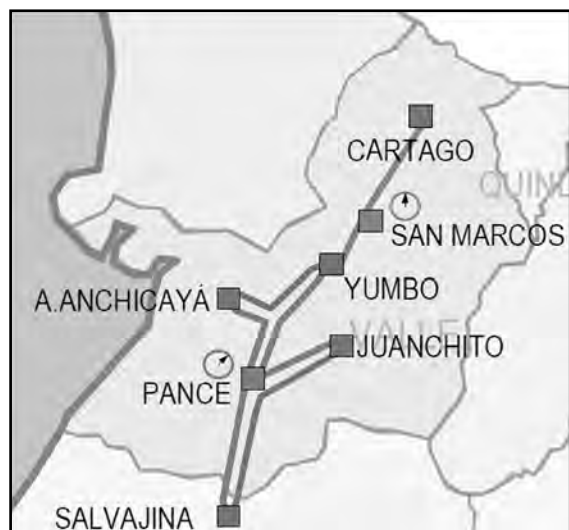
Figura 4. Sistema de transmisión del Valle del Cauca a nivel de 220 kV con PMU instaladas
