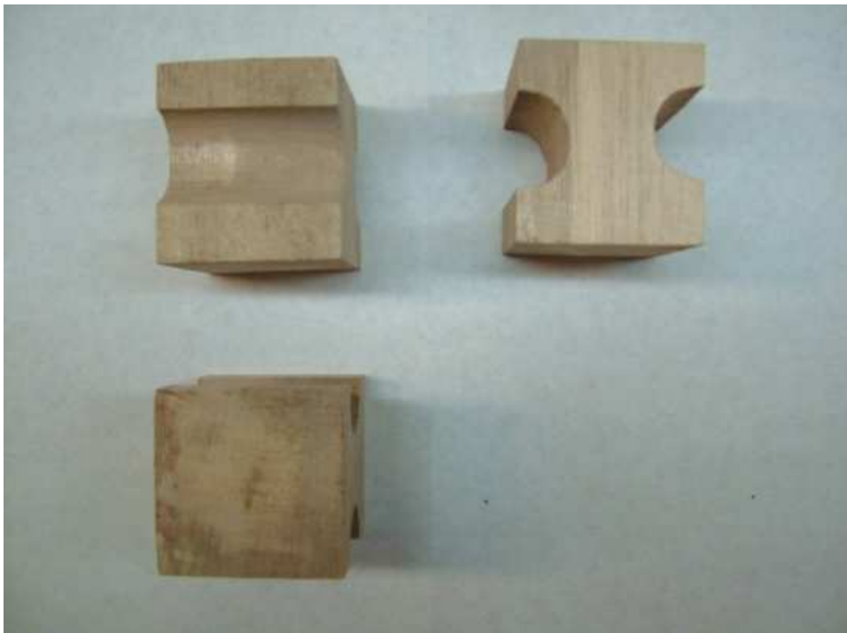
Figura 14. Vistas de la probeta de ensayo de tracción perpendicular al grano.
