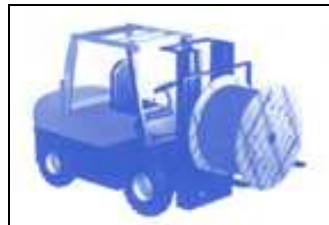
Figura 34. Máquina montacargas (grúa horquilla) sujetando un carrete.
