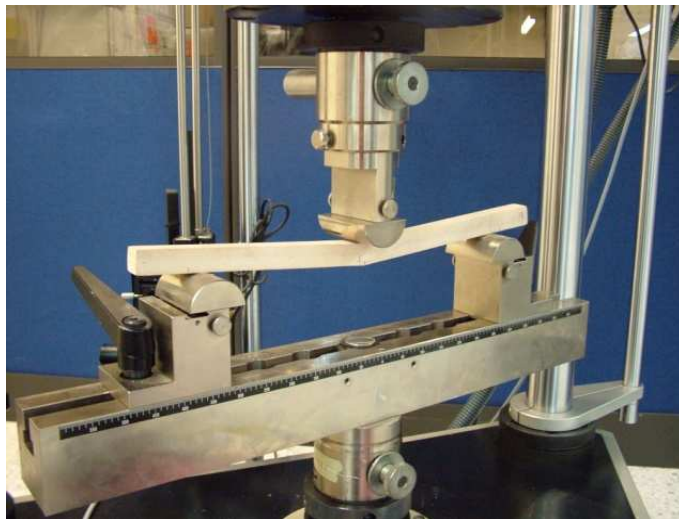
Figura 23. Máquina universal de ensayos UTS 200.3: Ensayo de flexión.
