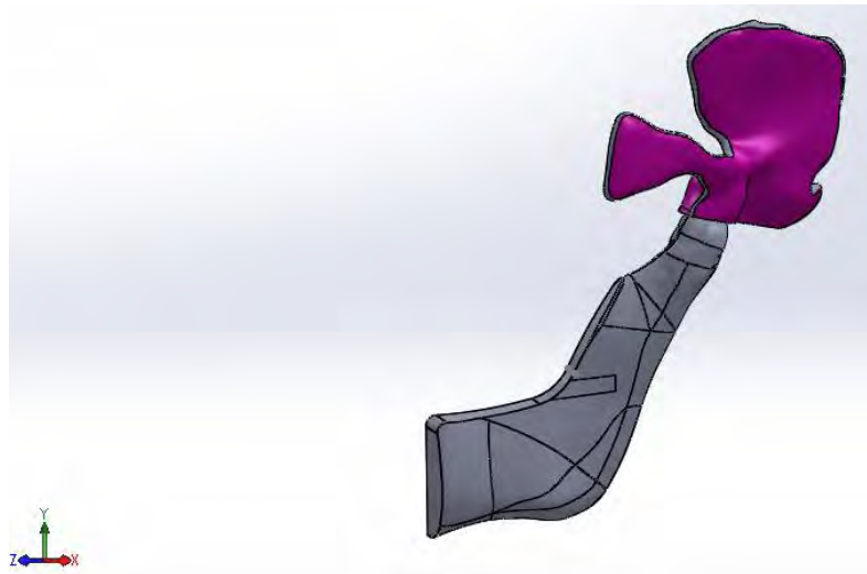
Figura 25. Modelo tridimensional de la prótesis hecha a medida diseñada en el proyecto; vista lateral.
