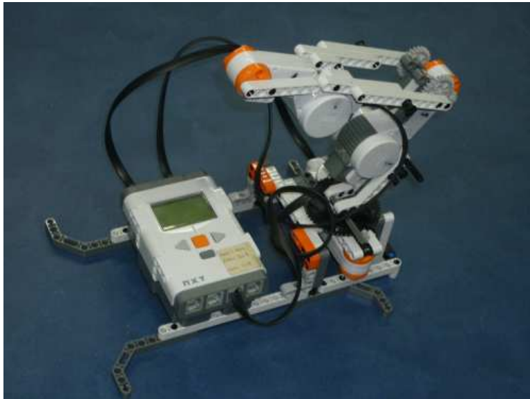
Figura 4. Lego Nxt armado como un robot manipulador.
