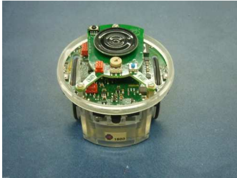
Figura 16. Robot e-puck. Seleccionado como principal y más adecuado para el desarrollo de la plataforma.
