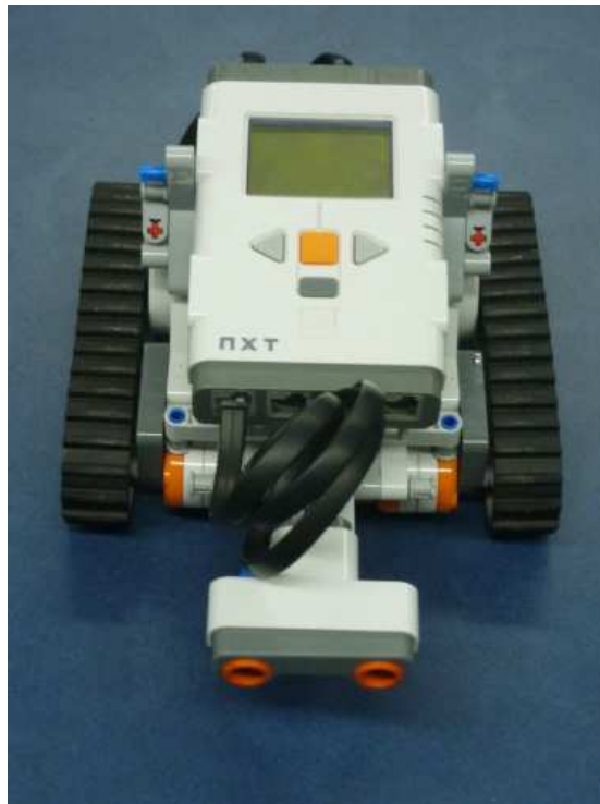
Figura 3. Lego Nxt armado como un robot móvil.
