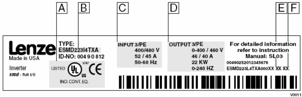
Figura 5. Placa de característica para el variador Lenze smd
