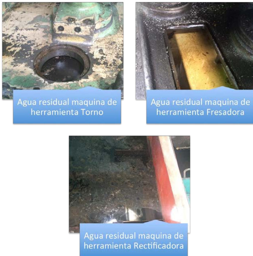
Figuran 9 Vertimientos de agua residual de las máquinas de herramienta Torno, Fresadora y Rectificadora
