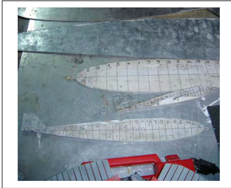
Figura 28. Construcción del perfil alar.
