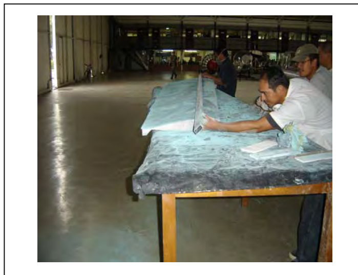
Figura 31. Angulo de Aluminio usado para medir la superficie alar.
