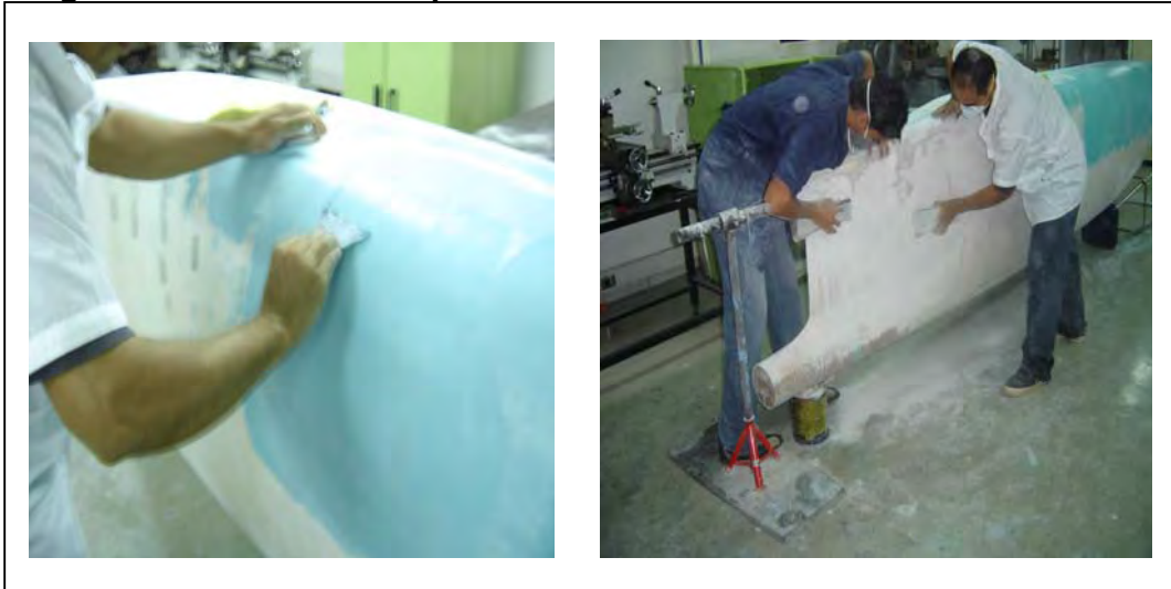
Figura 32. Pulido de la superficie.
