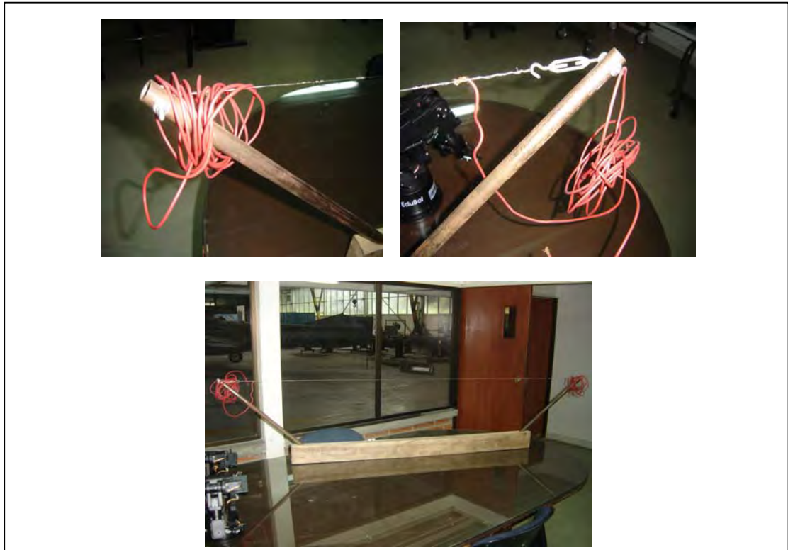
Figura 26. Estructura de madera, usada para el corte de icopor.
