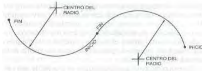
Figura 8. Se pueden generar formas complejas en varios ejes utilizando interpolación circular.
