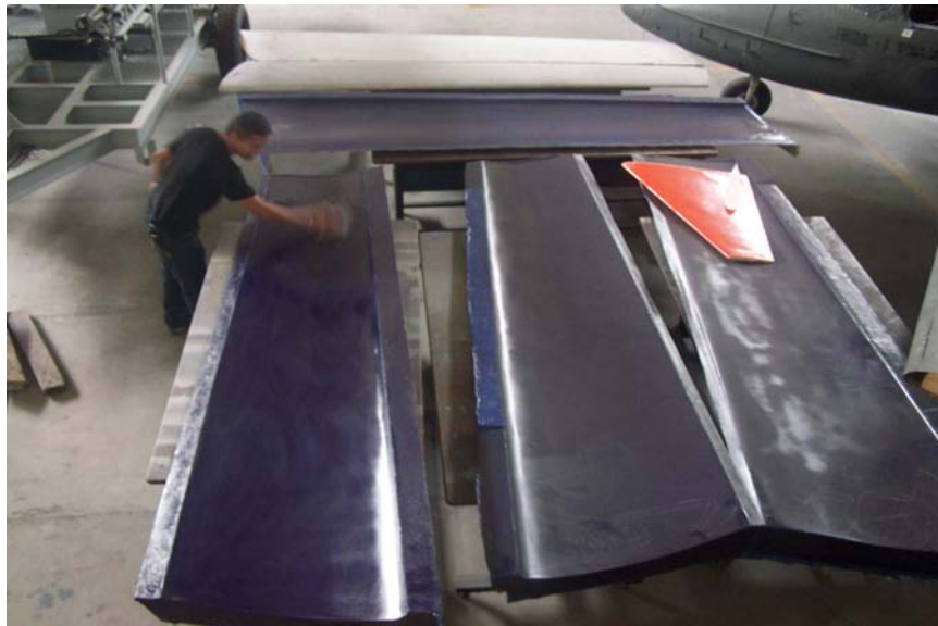
Figura 69. Molde del ala o plano derecho y plano izquierdo del avión X01-FAC.
