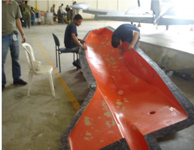
Figura 69. Molde del ala o plano derecho y plano izquierdo del avión X01-FAC.
