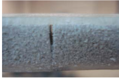
Figura 76. Problema de falta de penetración de la resina en las uniones del Divinigel.
