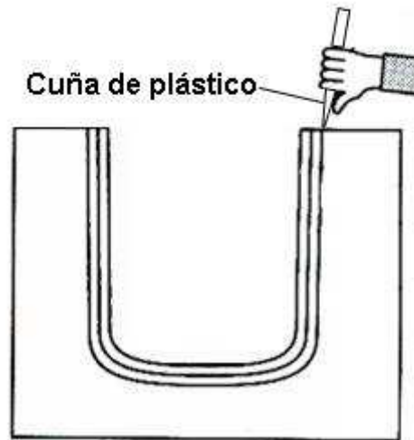
Figura 75. Desmoldeo de la pieza usando cuña de plástico.
