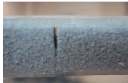
Figura 77. Problema de falta de penetración de la resina en las uniones del Divinice.
