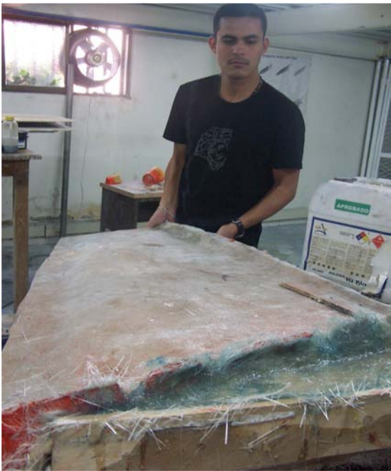
Figura 71. Molde del estabilizador horizontal del avión X01-FAC.
