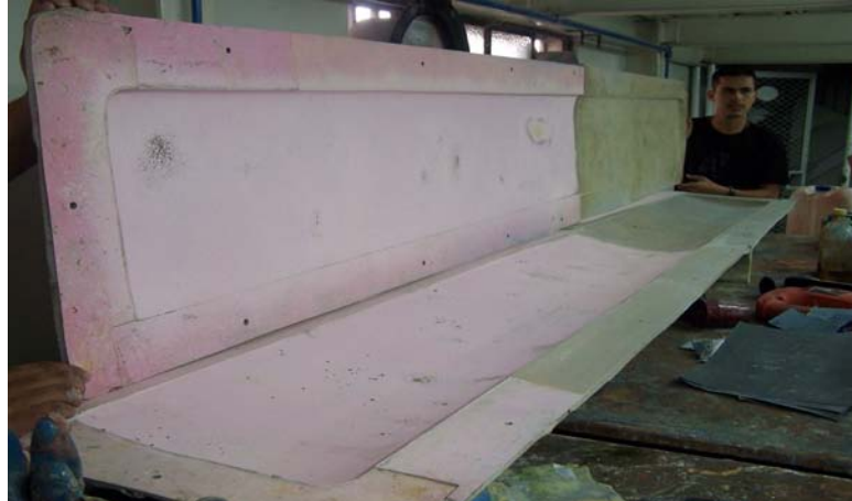
Figura 72. Molde del canard del avión X01-FAC.
