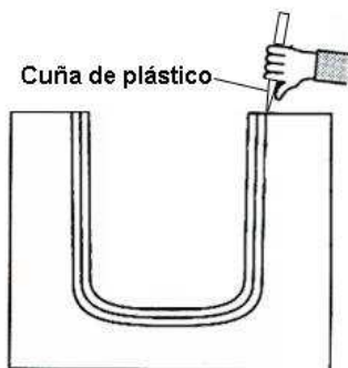
Figura 6. Desmoldeo de la pieza usando cuña de plástico.
