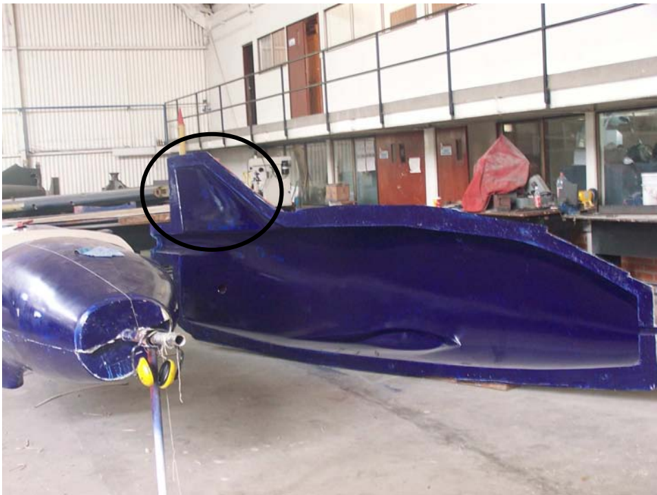
Figura 71. Molde del estabilizador horizontal del avión X01-FAC.
