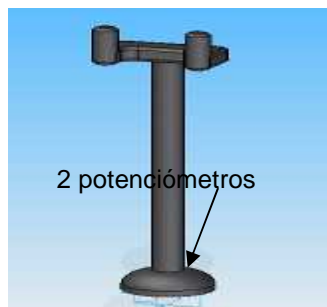
Figura 17. Generación de conceptos (Timón original con transmisión de movimiento)
