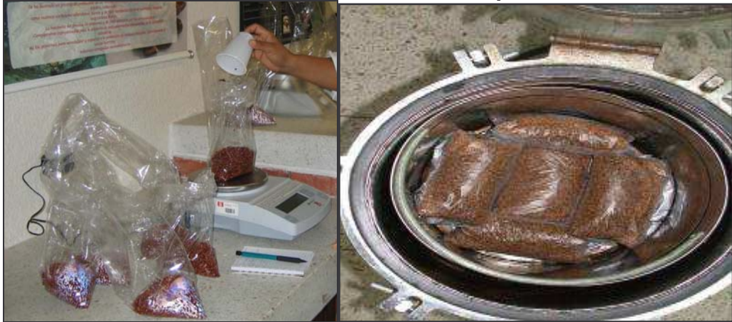
Fig. 29 Pesado y Esterilización del grano en bolsas plásticas
