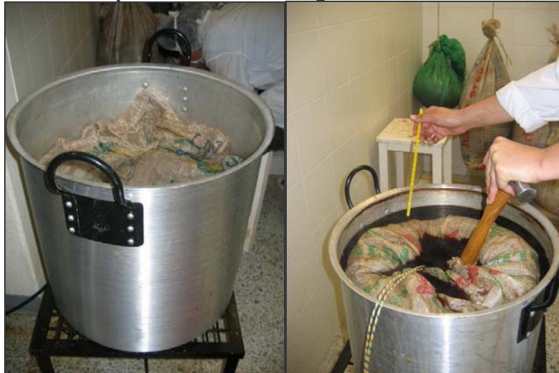
Fig. 36 Pasteurización por inmersión en agua caliente
