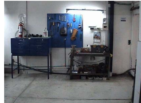
Foto 34. DESPUES Área de mecánicos despejada, reubicación del gavetero de repuestos y ubicación de motores en la estantería.
