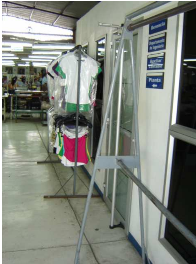
Foto 16. ANTES Obstrucción del pasillo principal Terminación - Oficinas
