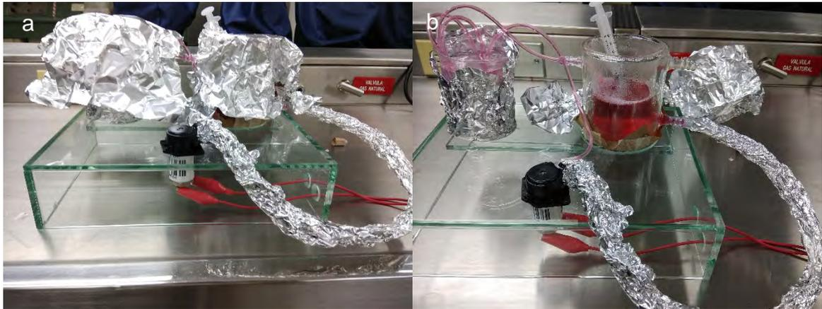
**Figura 12.** Dispositivo de recirculación. a) Vista del dispositivo funcionando durante la quimerización, totalmente cubierto para evitar la luz directa. b) Vista del dispositivo funcionando. Nota: Ambas fotografías fueron tomadas después de extraer el uréter del dispositivo, por lo cual no se afectó la protección de luz directa.
