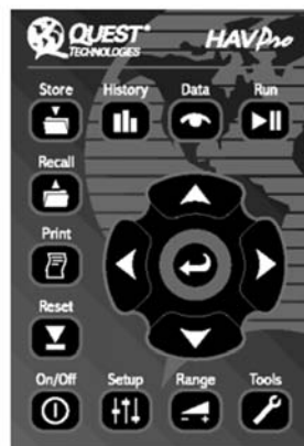
Figura 14. Modelo de la pantalla del monitor para medir vibraciones
