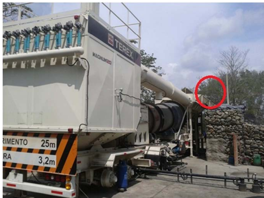
Figura 24. Planta de asfalto Terex Magnum120 (parte posterior)
