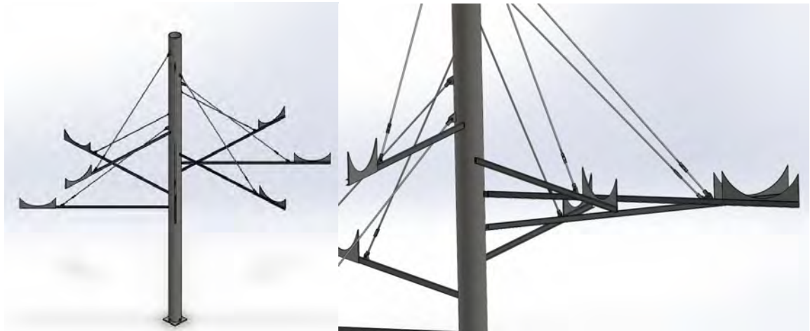
Fig. 19. Torre de soporte (a). Vista general. (b) Acercamiento torre de soporte.
