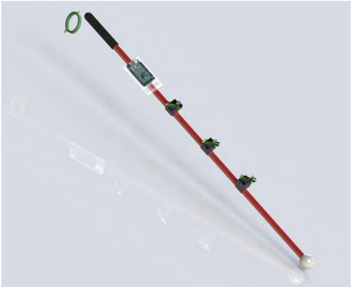
Figura 18. Modelo en 3D del bastón con sus componentes electrónicos.
