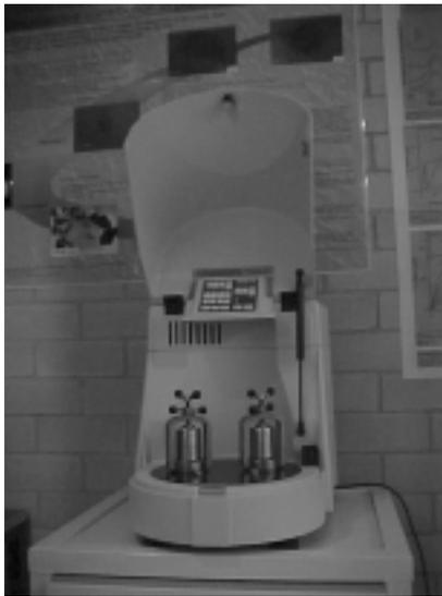
Figura 3. Molino planetario,<sup>5,6</sup>
