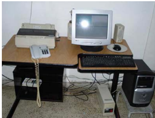
Figura 4. Monitor mal ubicado, mouse no esta a nivel del teclado, exceso de equipos debajo del puesto de trabajo
