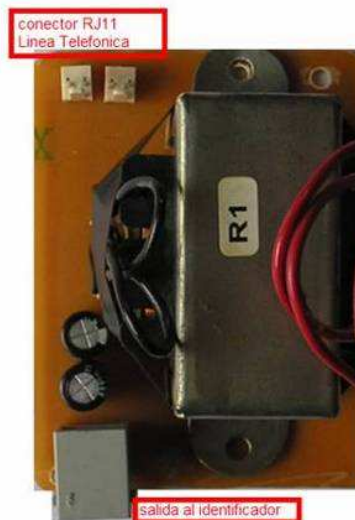
Figura 40. Montaje de la etapa de aislamiento del identificador.
