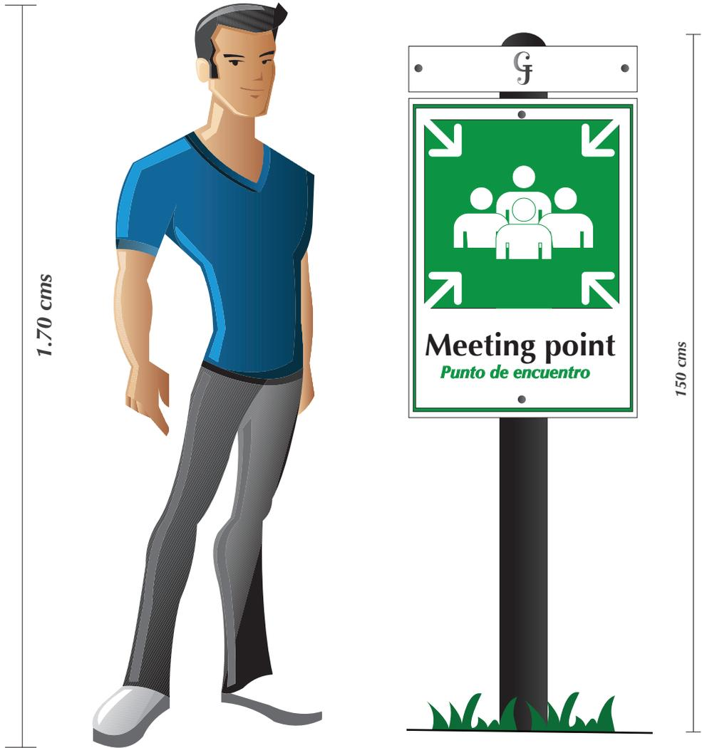
Figura 77. Ilustración altura de módulos de aplicación señales direccionales ancladas al suelo
