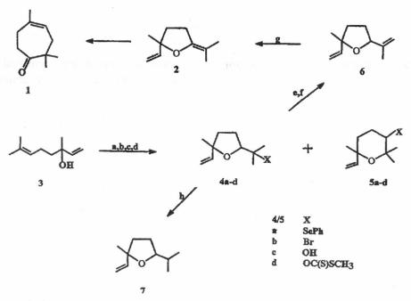
a) PhSeCl, CH<sub>2</sub>Cl<sub>2</sub>, - 78 °C; b) NBS, CCl<sub>4</sub>, RT; c) 3-Chloroperbenzoic acid, CH<sub>2</sub>Cl<sub>2</sub>, RT; d) NaH, CS<sub>2</sub>, THF; e) Collidine, 110 °C; f) 200 °C; g) RhCl<sub>3</sub>, RT; h) Bu<sub>3</sub>SnH, toluene, 110 °C
