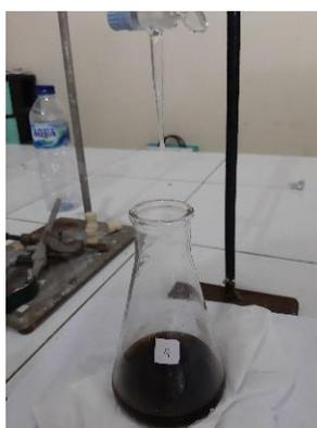
**Gambar 6.** Pengujian Kadar Alkali Bebas
