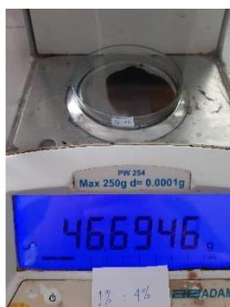
**Gambar 5.** Pengujian Kadar Air
