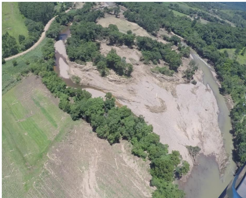
Figura 2-7. Depósitos de sedimentos que provocaram alterações na morfologia do canal principal da bacia do rio Mascarada/RS.
