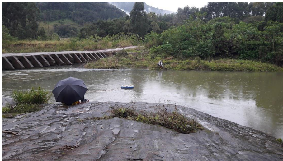
Figura 2-10. Medição de vazão na seção de monitoramento com o equipamento ADCP M9.
