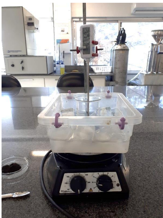
Figura 4.1 - Montagem do experimento para obtenção do óxido de grafeno (OG) a partir do método de Hummers.
