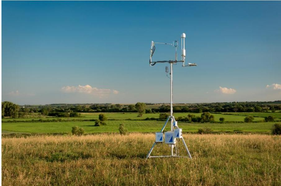
Figura 3 - Equipamentos de medição utilizados por torres EC. O sistema é composto por analisador de gases, anemômetro ultrassônico e um sistema para armazenamento, aquisição e processamento dos dados. Fonte: ELITE SCIENTIFIC INSTRUMENTS SDN BHD<sup>3</sup>.
