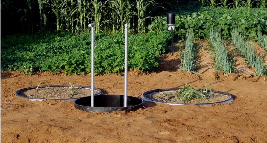
Figura 2 - Exemplo da instalação de lisímetros para medições de *ET* para uma cultura de vegetação específica. Fonte: Lysimeter<sup>2</sup>.
