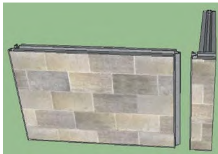
Gambar 4.14 Ilustrasi Dinding Sudut
