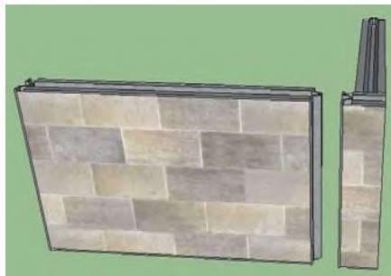
Gambar 3.5 Ilustrasi Dinding Sudut
