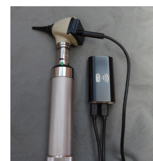
Oftalmoscopio y Endoscopio. La propuesta es añadir una cámara de alta definición
