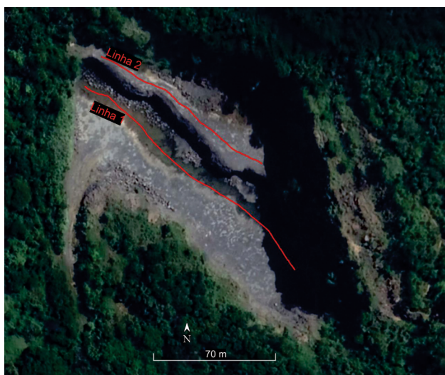
Figura 7. Imagem aérea de localização das linhas de Ground Penetrating Radar (GPR) levantadas na pedreira.
