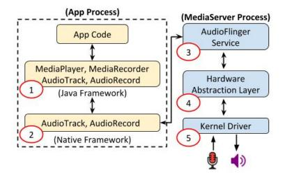
Fig. 4.7.: Android Audio Architecture
