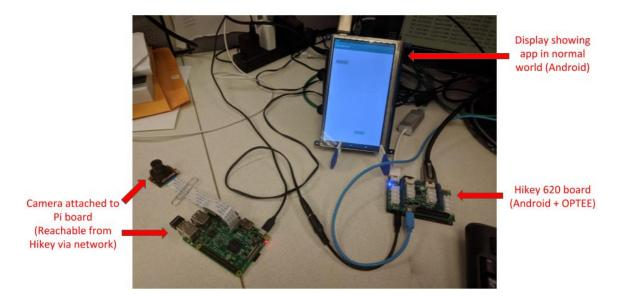
Fig. 5.22.: Camera Test Setup
