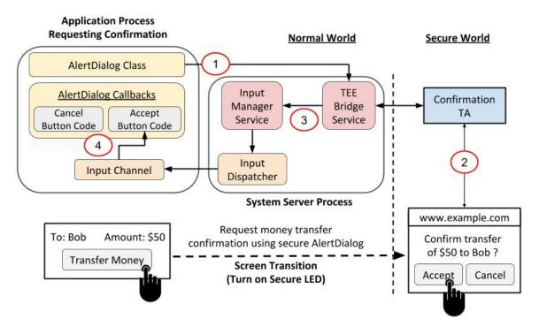
Fig. 3.8.: AlertDialog Confirmation using TEE
