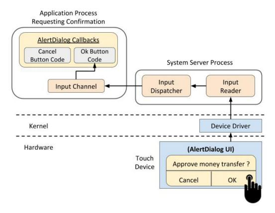
Fig. 2.8.: Trigger Dialog Button Code
