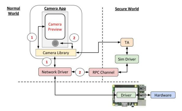
Fig. 5.6.: Camera Access Design
