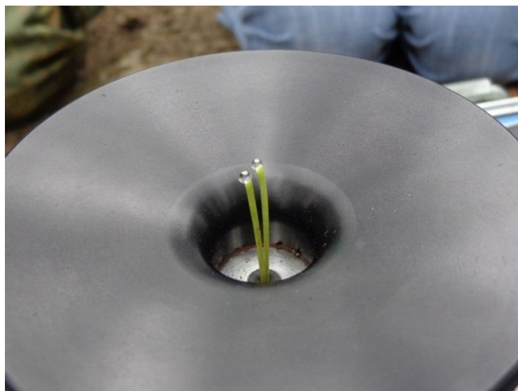
Obrázek 3-2 Scholanderova tlaková bomba- xylémová šťáva vytlačená z listu topolu osiky zvýšeným tlakem.
