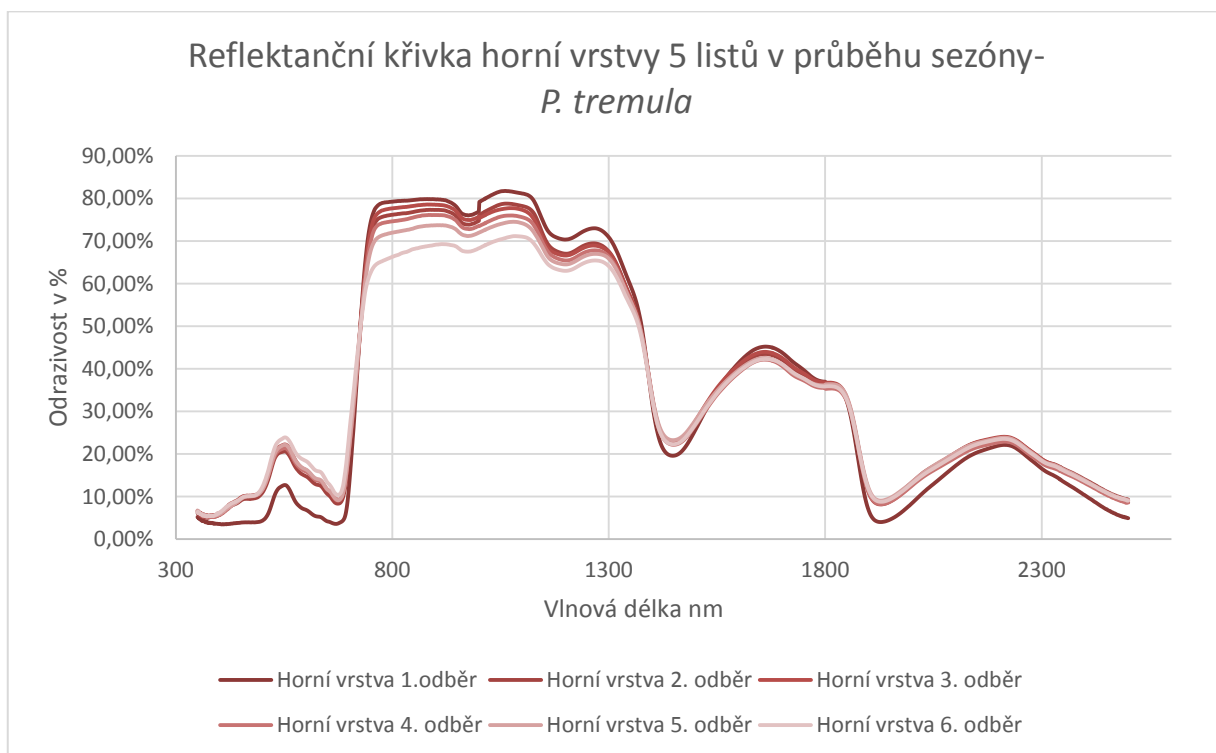
Graf 4-38 Reflektanční křivka topolu osiky, změny v odrazivosti vrchní strany vrstvy 5 listů v průběhu sezóny. Odrazivost je zaznamenána v % a na ose x jsou jednotlivé vlnové délky.
