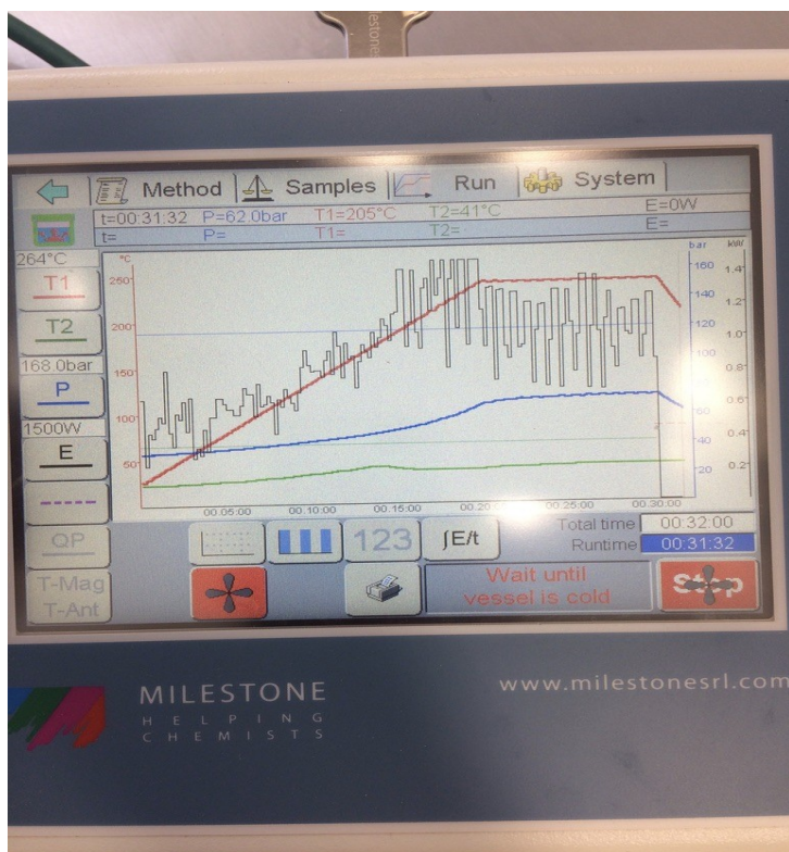
Obr. 3.3 – Grafický průběh rozkladného procesu, fotografie pořízená v laboratoři
